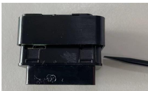
Figura 4 – Remover a capa
