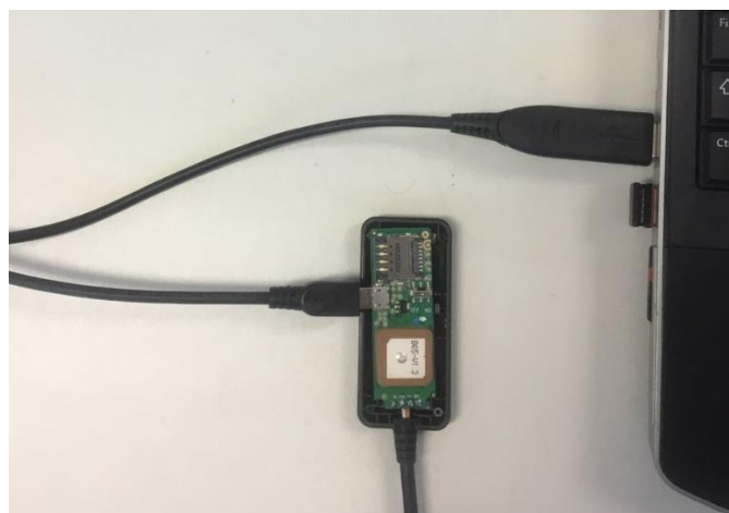
Figura 8 – Conexão do cabo USB/SERIAL
